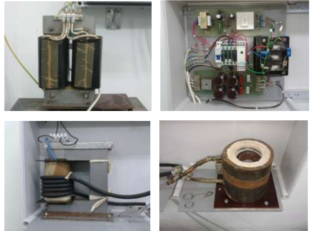
Fig. 7.6 Imaginile instalației din laborator : transformatorul de alimentare, sursa de medie frecvență, transformatorul de adaptare și cuptorul cu creuzet
